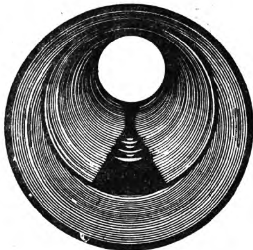
Рис. 1. Вид горохообразных раздутий со стороны казенной части ствола при их обнаружении способом теневого треугольника.
