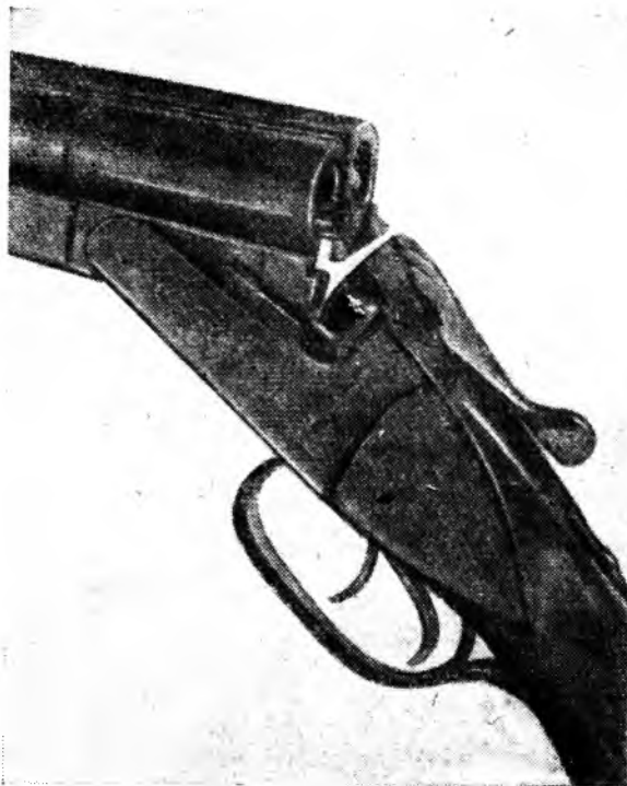
Двуствольное ружье ИЖ-58 в раскрытом виде.
