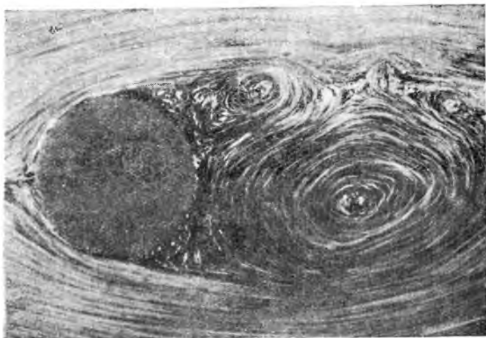
Фиг. 30. Спектр обтекания воздухом цилиндра.
