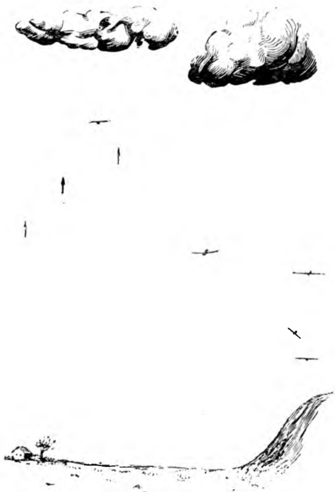
Фиг. 136. Схема парящего полета планеров в потоках обтекания усиленных термиками.
