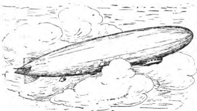
Фиг. 34. Обтекаемая форма современного дирижабля.
