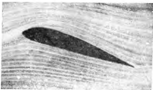
Фиг. 50. Спектр обтекания воздухом крыла.
