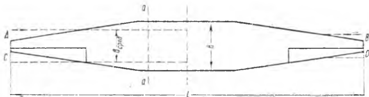
Фиг. 42. Крыло планера в плане (вид сверху).
