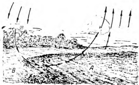
Фиг. 134. Восходящие и нисходящие токи воздуха вследствие неравномерного нагрева солнцем земной поверхности:
