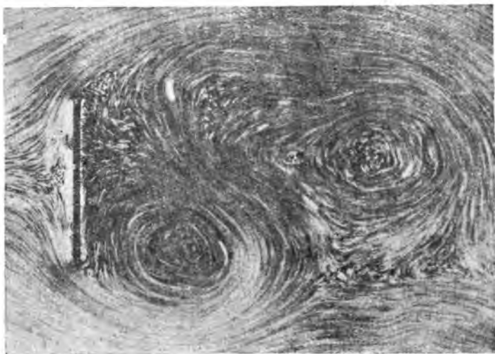
Фиг. 29. Спектр обтекания воздухом плоской пластинки.
