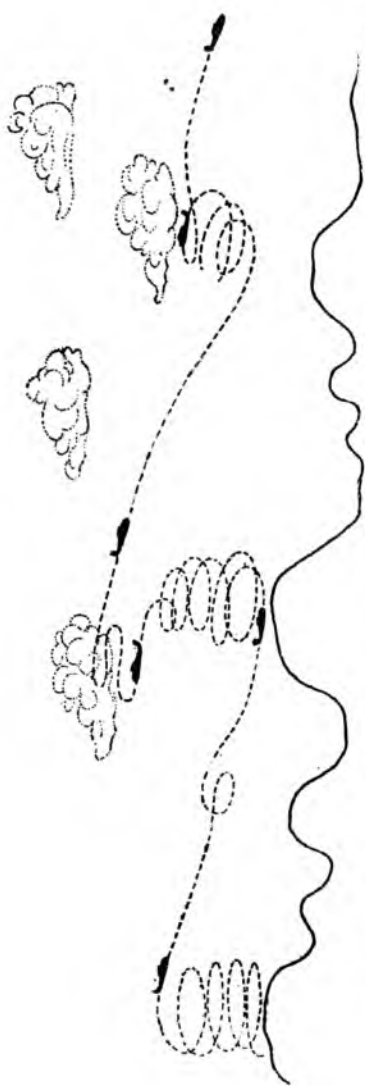
Фиг. 140. Схема парящего полета на дальность при комбинированном использовании потоками обтекания, термиками и кучевыми облаками.
