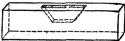
Рис. 306. Отверстие со скошенными внутренними гранями.
