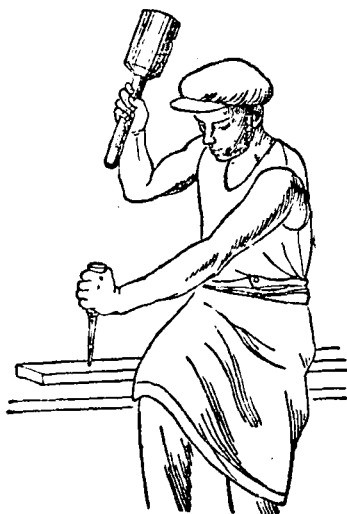
Рис. 307. Правильный прием выдалбливания отверстий.
