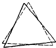
Рис. 297. Пример несоответствия торцевых профилей.
