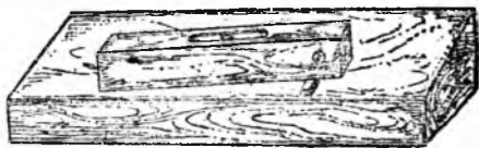
Рис. 263. Проверка ватерпасом неправильной подоконной доски.
