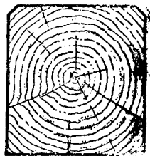
Рис. 292. Кромки бруска, застроганные по риску рейсмуса.
