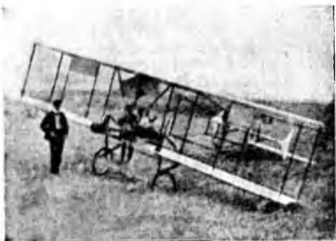
„Сикорский“ № 1 с Анзани 15 лош. сил после полета в 1 мин. 20 сек. 5-го июня 1910 г. с подломанным колесом (велосипедным).
