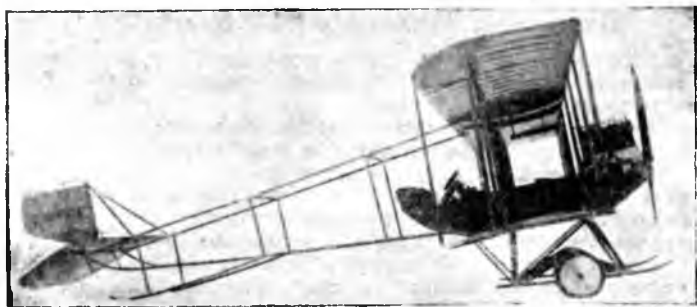
„Сикорский“ № 6 с Аргусом 100 лощ. сил. Последний биплан Сикорского с фермой. В 1911 г. он показал скорость с тремя на борту в 100 км.ч.
