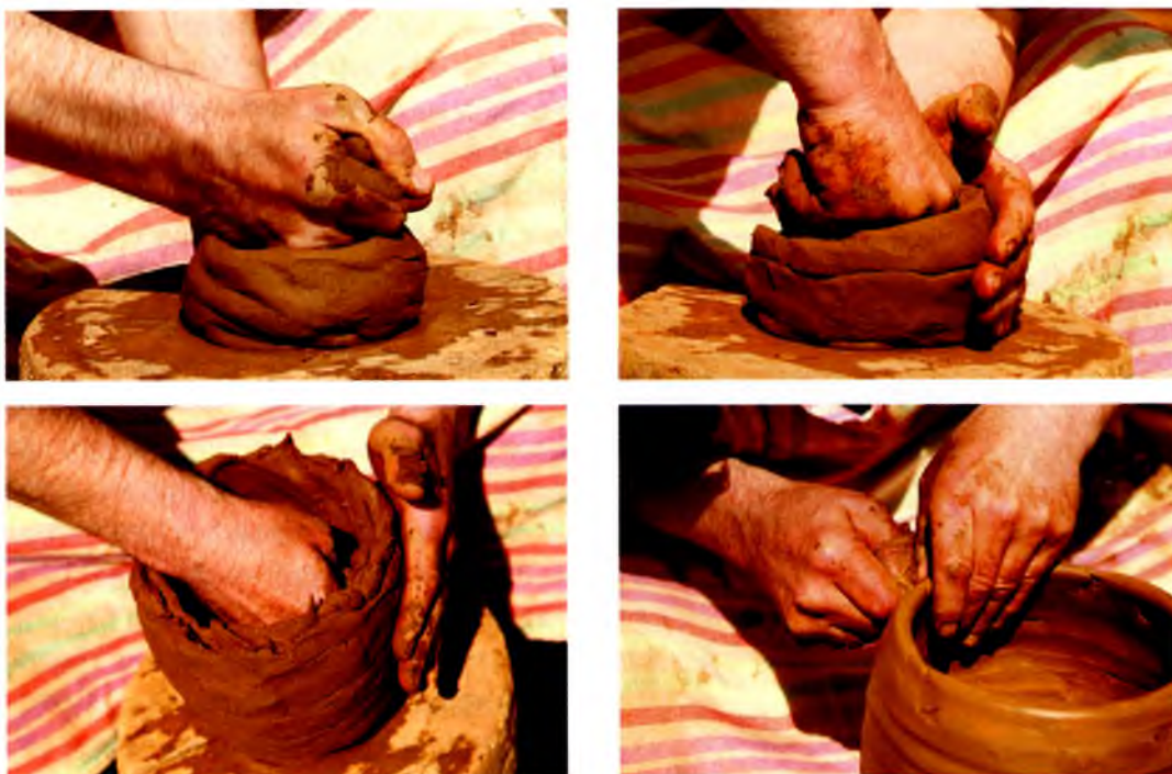
4. Формовка сосуда по восстановленной архаичной технологии (фото слева направо сверху вниз): зачин, наращивание высоты скалами-жгутами, обработка края сосуда
