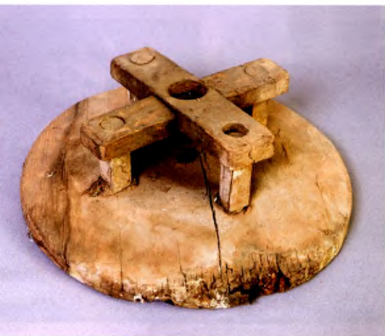
4. Гончарный круг. 1950-е гг. На этом круге работал гончар Чистяков И.А. Д. Горка, Череповецкий р-н
