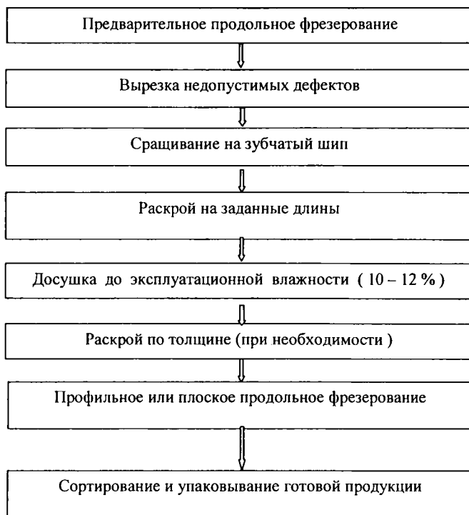
Рис. 6.1. Схема технологического процесса производства клееной пиломатериалов
