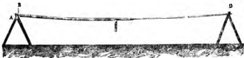
Фиг. 2. — Приготовленіе водостока, чрезъ соединеніе трубъ асфальтомъ.
