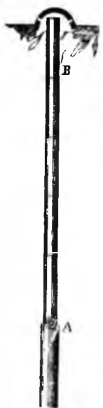
Фиг. 7.—Восходящая ирригационная трубка.
