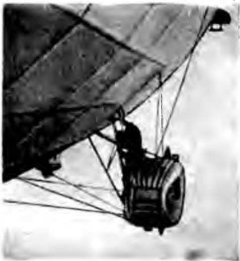
Фиг. 74. Лесенка (трап) для сообщения в полете между моторной гондолой и корпусом дирижабля.
