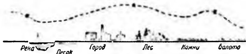
Фиг. 4. Влияние характера местности и почвы на траекторию полета аэростата (зиг-заг такой зависимости нет). Крест как и (X) отмечены места, где нужно травить балласт, чтобы получить ровную линию полета.
