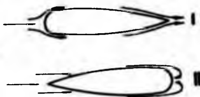
Фиг. 29. Значение заостренности кормы для наилучшего обтекания тела.
