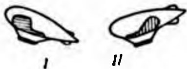
Фиг. 32. Применение баллонетов для управления дирижаблем (подъема и спуска)
