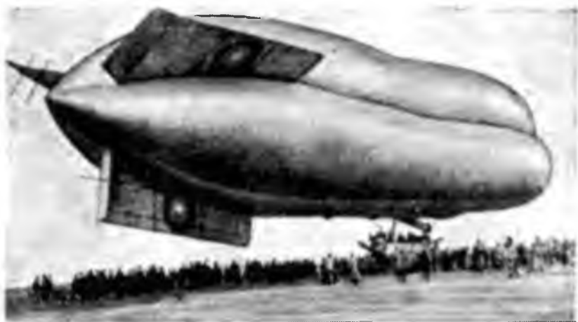
Фиг. 24. Дирижабль «Черномор» объемом 4500 м 3 , два мотора по 150 л. с.
