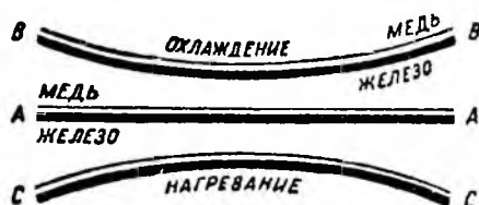
Рис. 44. Изгибание пластинки, склепанной из железа и меди, при нагревании и охлаждении.
