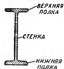
Рис. 95. Сечение двутавровой балки.
