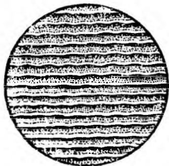
Рис. 38. Часть граммофонной пластинки (в увеличенном виде).
