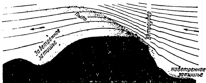
Рис. 3. Профиль гряды, силы ветра и мест сдувания и надувания
