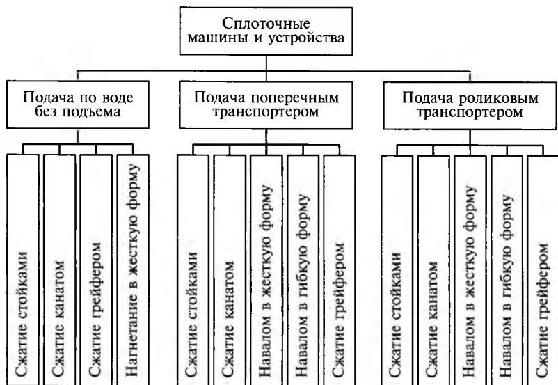
Рис. 4.8. Классификация сплоточных машин и устройств для сжатия пучков из круглых лесоматериалов
