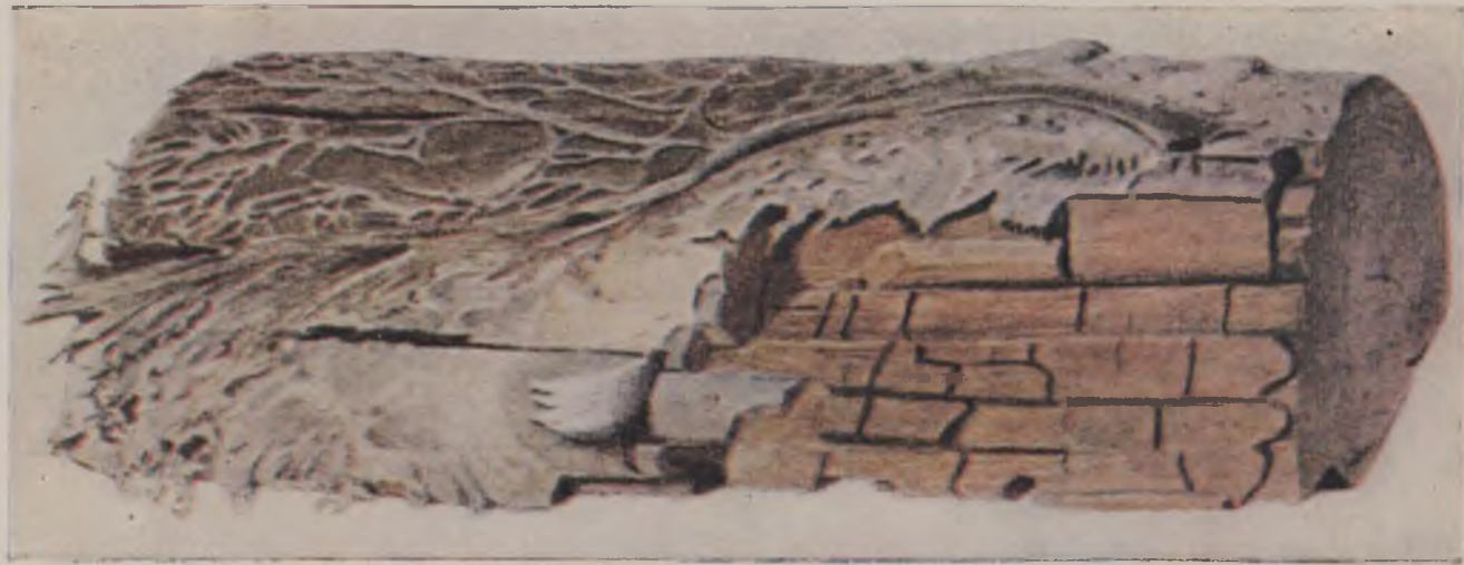
Рис. 16. Разрушенная древесина, покрытая старой гребницей и шнурами гриба мерулуус лакриманс
