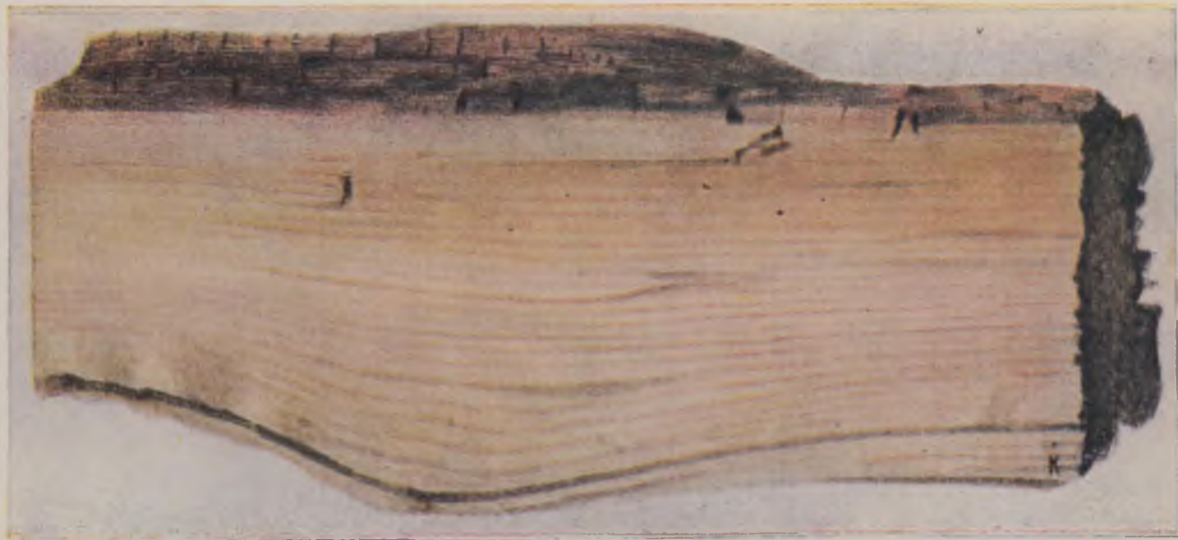
Рис. 1. Древесина сосны в разных стадиях разрушения грибом мерулиус лакриман
