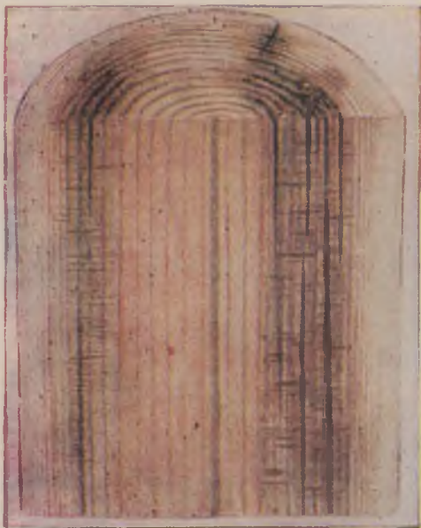
Рис. 66 Древесина сосны с гнилью в третьей стадии поражения
