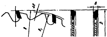
Рис. 6.2. Профили зубьев безопасных пил
