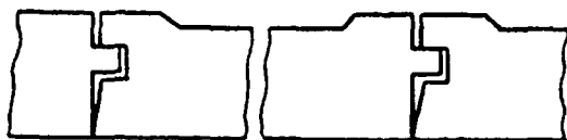
Рис. 2.16. Эскиз доски пола для чистых полов
