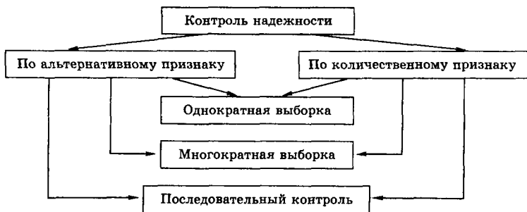
Рис. 4.2 Структурная схема контроля надежности
