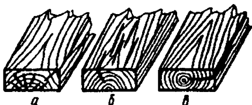
Рис. 3.6. Трещины: а - торцовые; б - пластевые; в - кромочные
