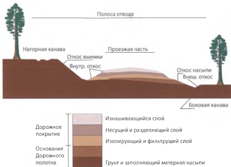
Рис. 1. Элементы дороги в поперечном профиле (Metsäteho)
