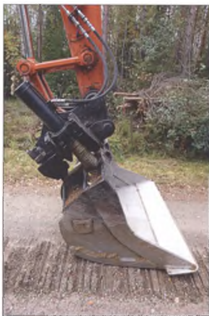
Рис. 13. На экскаваторе установлен планировочный ковш
