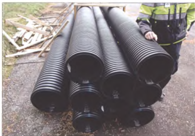
Рис. 6. В Финляндии используются пластиковые гофрированные трубы диаметром 30-50 см
