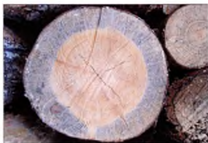
Рис. 12. Синева – самый распространенный цветовой дефект, снижающий эстетическое качество древесины
