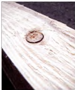
Рис. 5. Сучки снижают визуальное качество и прочность лесоматериала
