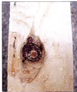
Рис. 5. Сучки снижают визуальное качество и прочность лесоматериала
