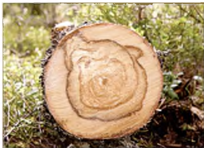
Рис. 11. Гниль влияет на характеристики прочности пиломатериалов и повышает потребление энергии и отбеливающих реагентов при производстве целлюлозы
