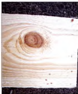
Рис. 5. Сучки снижают визуальное качество и прочность лесоматериала
