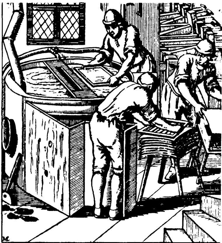
Изготовление бумаги вручную на старинной бумажной мельнице
