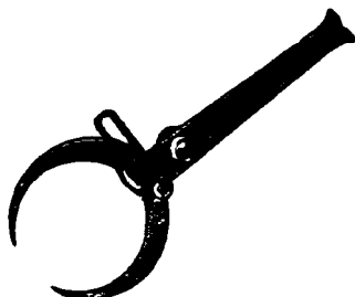
Танцмейстеръ, внутренній крумциркуль.
