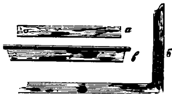
а. Желѣзная линейка; б. желѣзный угольникъ; в. фальцъ-линейка.
