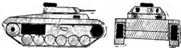
Рис. 14 и 15. Наиболее уязвимые места германского танка „Т-III“.
