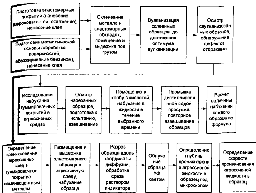
Рис. 4.3. Методика проведения экспериментов по исследованию химической стойкости гуммировочных покрытий в агрессивных средах
