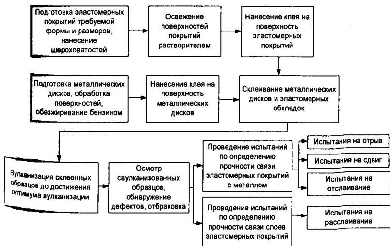
Рис. 4.4. Методика проведения экспериментов по определению прочности крепления гуммировочных покрытий
