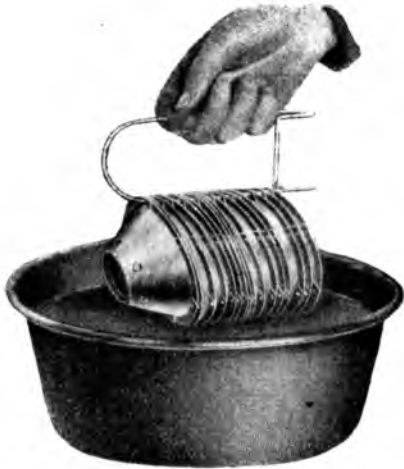
Рис. 59. Тарелки сепаратора „Альфа“ на кольцѣ для промыванія.
