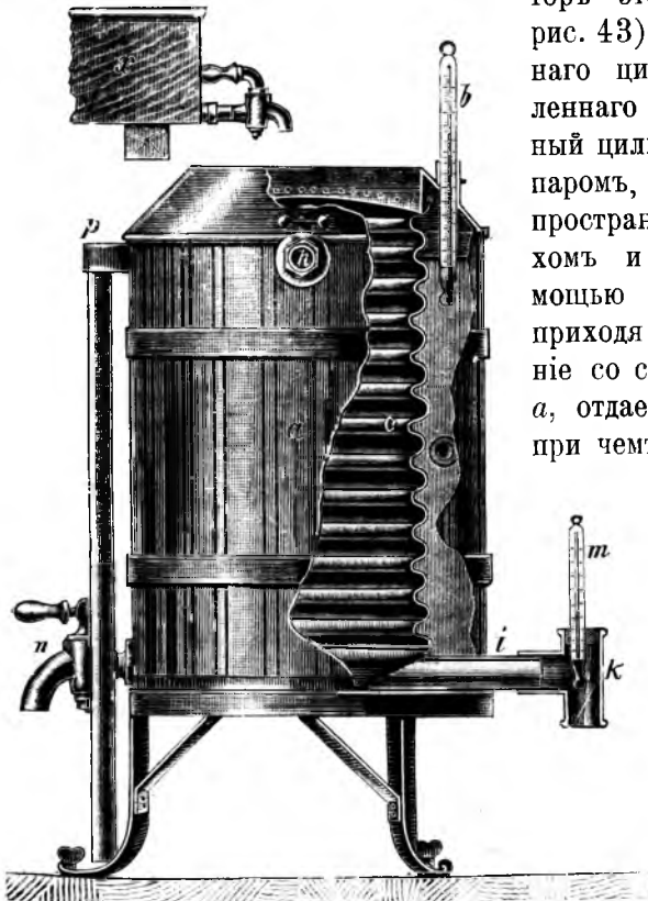
Рис. 44. Аппаратъ К. Твля. a —деревянный кожухъ; p —паровая труба; i k —выводная трубка для молока; m —термометръ для молока; h —кранъ для спуска конденсаціонной воды; x —резервуаръ для молока.
