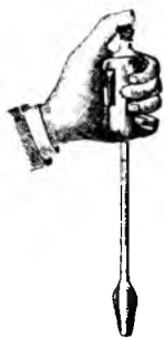
Рис. 12. Бутирометръ, вставленный въ футляръ для встряхиванія.
