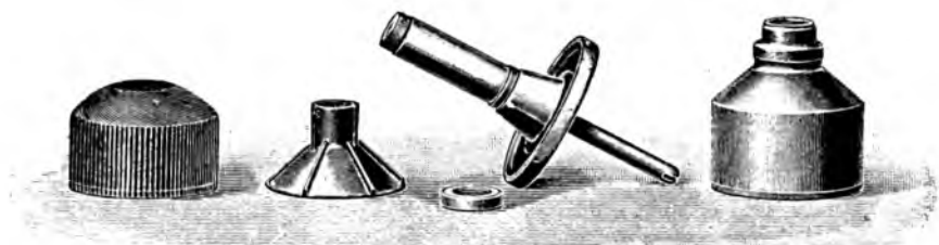
Рис. 83. Барабанъ сепаратора „Пумпъ“ въ разобранномъ видѣ.
