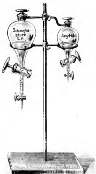
Рис. 11. Автоматическій приборъ для отмѣриванія кислоты и спирта.
