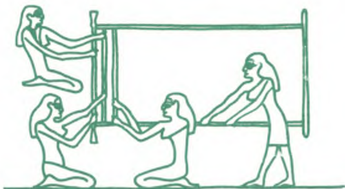
Снование, подготовка ткацкого навоя и перенос основы на ткацкий станок в Древнем Египте. Роспись на стене одной из гробниц
