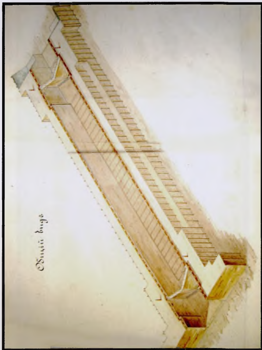
Общий вид однокамерного шлюза. 1896 год.
