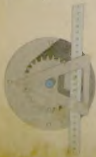
Механизм для открытия шлюзовых ворот. 1896 год.
