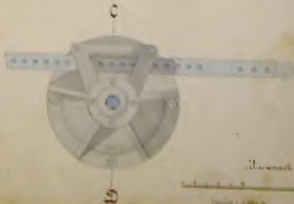
Механизм для открытия шлюзовых ворот. 1896 год.
