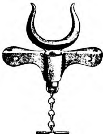
Рис. 81. — Откидная уключина, состоящая из двух металлических рычагов, соединенных в центре, с цепочкой внизу.
