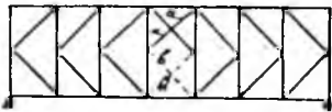
Стат.—опредѣлима, если раск. а, в жесткаго сѣченія, а раск. б, в—плоскаго сѣченія, или наоборотъ.
