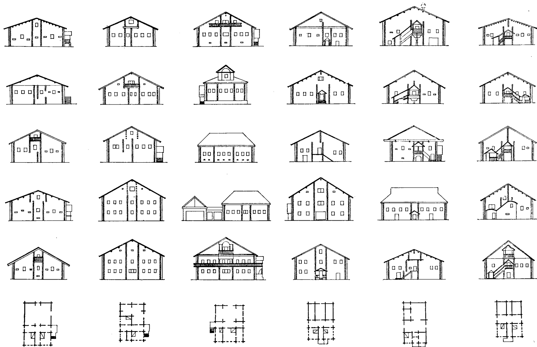
Табл. 68. Сводная таблица типов шестистенных изб.
