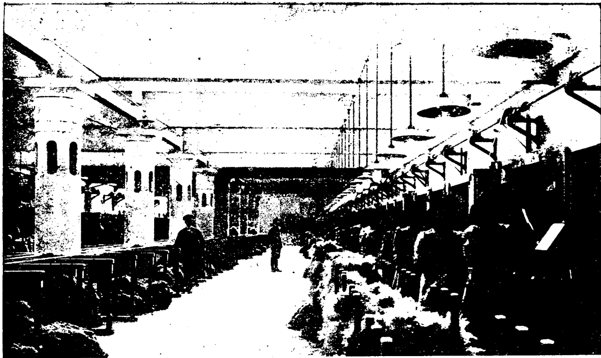
Рис. 208. Трепальное отделение на льнообделочном заводе в Германии.
