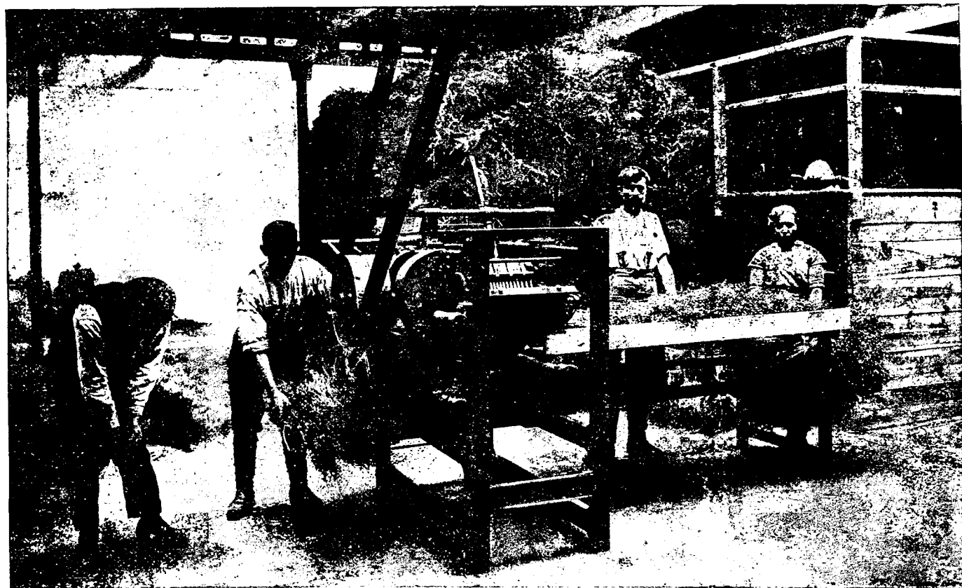
Рис. 84. Ирландская машина для обрывания льняных головок.
