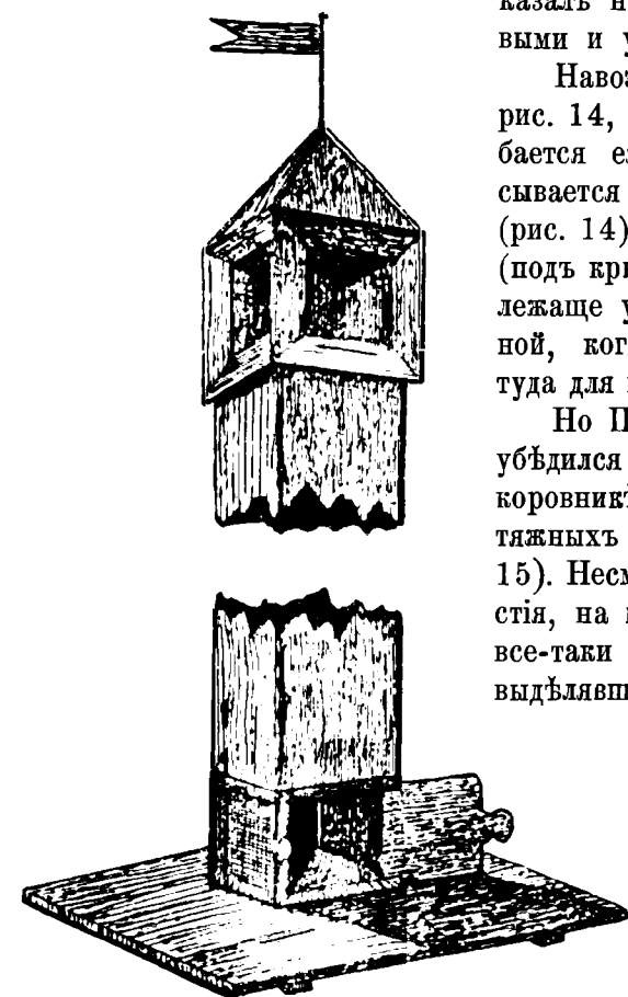
Рис. 16. Внешній видъ трубы системы Муира для вентиляціи.
