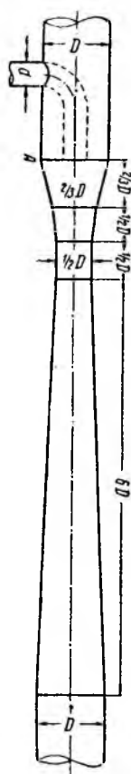
Рис. 2. Эжектор типа Venturi. D — от 3 до 6 d
