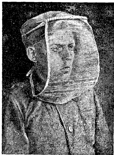
Рис. 7. Сетка для защиты лица от теплового излучения
