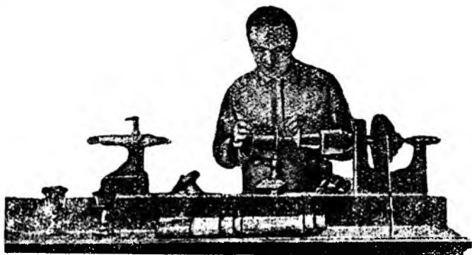
Рис. 75. Полировка точеных деталей на токарном станке
