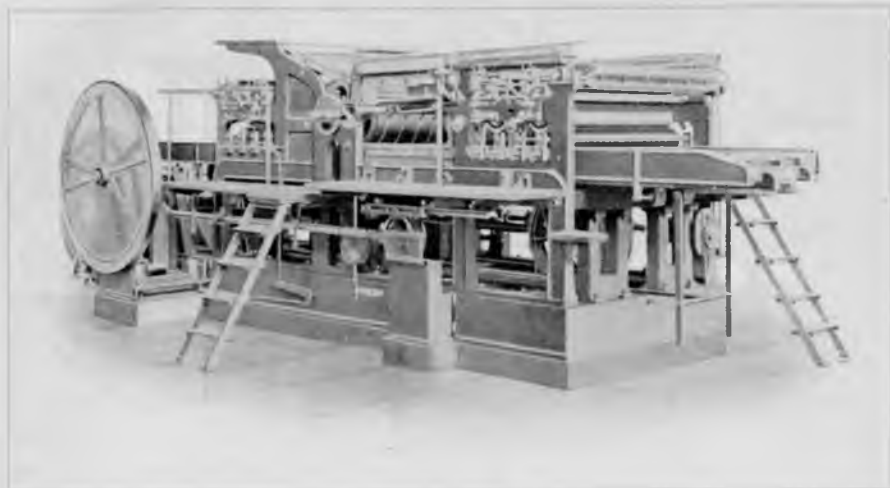
Двухкрасочная скоропечатная машина с цилиндрическим растиранием краски, с четырьмя накатными валиками.
