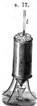
Опредѣленіе нуля на термометрѣ.
