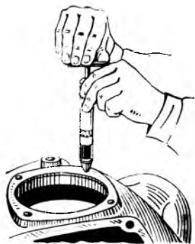
Рис. 21. Установка резьбовой вставки в крышку кожуха муфты сцепления двигателя СМД-14.
