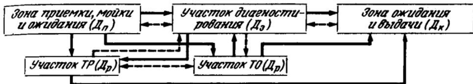
Рис. 4.1. Схема включения диагностирования в технологический процесс СТОА:
