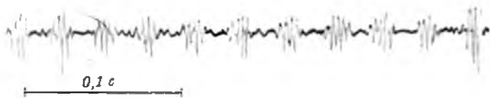
Рис. 89. Вибрации во время виляющего пробега, записанные акустическим методом. (По Г. Эшу.)
