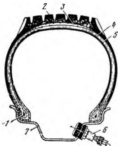
Рис. 3. Бескамерная шина:
