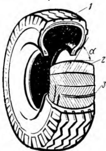
Рис. 2. Покрывка с диагональным расположением нитей корда в каркасе:
