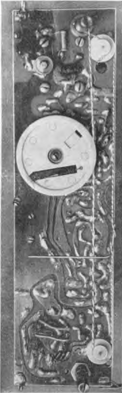
Рис. 6. Размещение деталей шкально-вернерного механизма на печатной плате.
