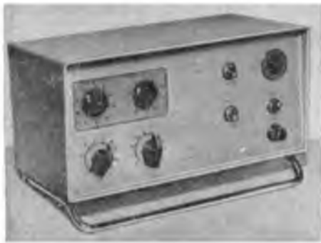
Репродукционный экспозиметр львовских радиолюбителей Л. В. Гущиной, В. А. Колонтай, Д. Н. Назарова (XXIV ВРВ).
