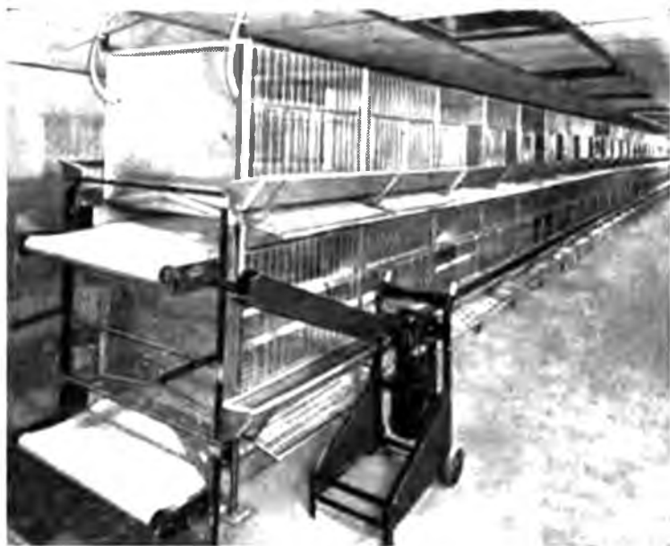
Рис. 20. Клеточная батарея для родительского стада кур (фирма «Беттервей кейджис», Англия).
