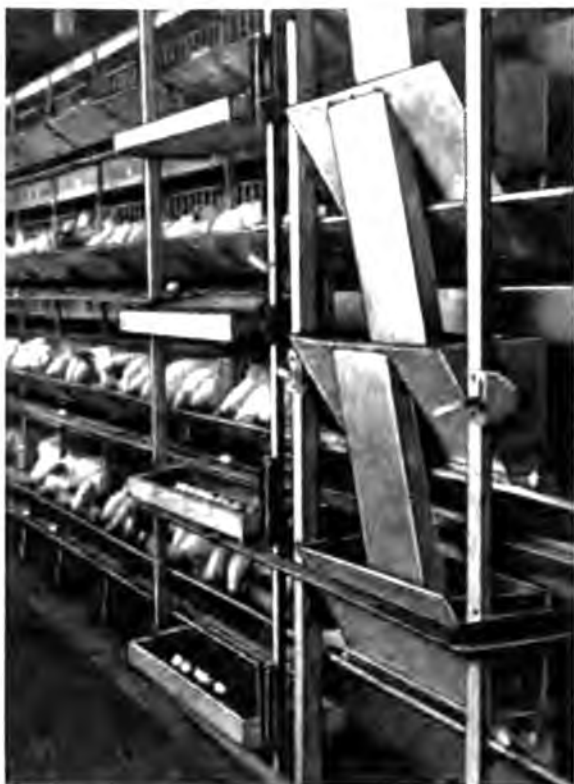
Рис. 17. Бункерный кормораздатчик батареи КБН; слева от него виден яйцесборник.
