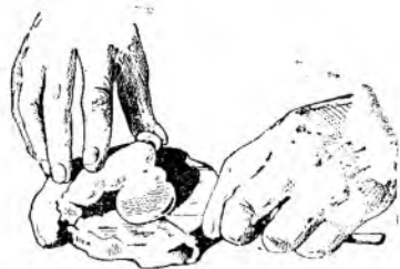
Рис. 2. Модель обкладывают глиной до карандашной черты
