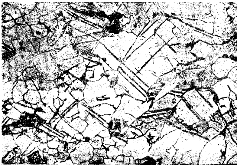
Рис. 6. Линии скольжения на зернах феррита. Реактив Фри. Лин. увел. 20
