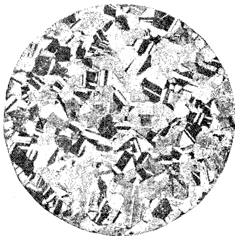
Рис. 80. Зерно № 6. 0,065 мм. \times 75
