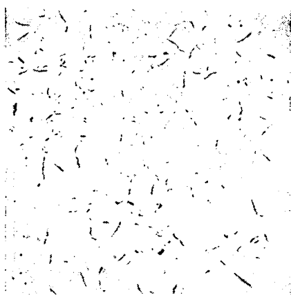
Рис. 57. Графитовые включения длиной 1,5—3 мм. Балл 7. \times 100
