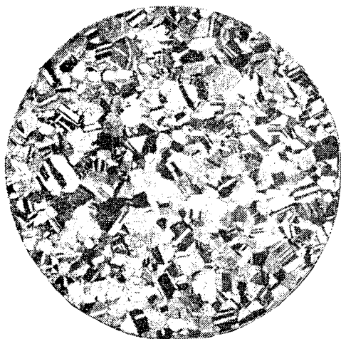
Рис. 79. Зерно № 5. 0,045 мм. \times 75
