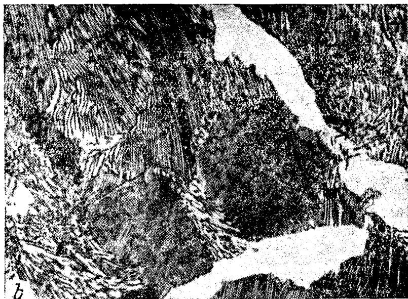
Рис. 59. Искривление микроструктуры доэвтектоидной стали в результате пластической деформации при шлифовке и полировке:
