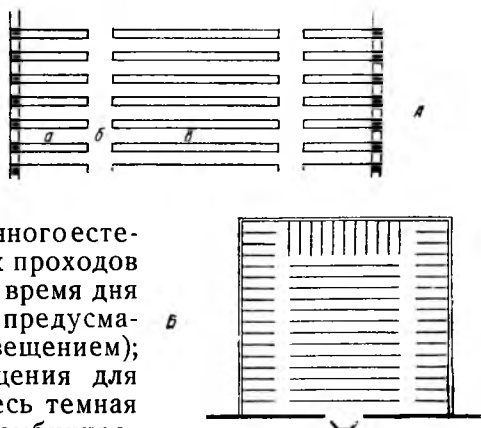
110. А—схема книгохранилища с комбинированной освещенностью, предложенная инж. В. Б. Вейнбергом и обработанная арх. Ф. Н. Пащенко, Б—то же при вертикально развитом или башенном построении книгохранилища
