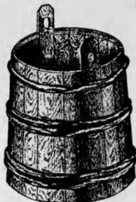
Рис. 9. Ушат из древесины хвойных пород с деревянными обручами
