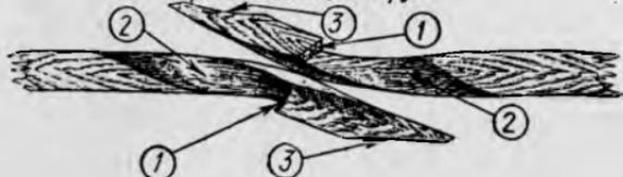
Рис. 25. Замок деревянных обручей: 1—зарубки, 2—выемки, 3—срезы концов обруча
