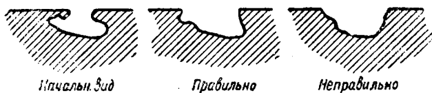
Фиг. 75. Придание раковине открытой формы для устранения завихрений при металлизации.
