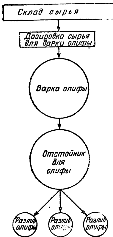
Рис. 1. Схема технологического процесса производства смоляной олифы кустарным способом.
