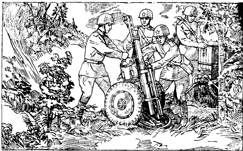
Рис. 112. Миномётный расчёт устанавливает миномёт на огневой позиции. Опрокидывая колёсный ход, опускают опорную плиту прямо в подготовленный для неё ровик.
