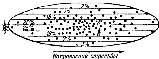
Рис. 145. Закон рассеивания по направлению: АБ—ширина одной полосы (срединное боковое отклонение).
