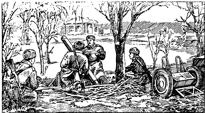
Рис. 19. Полковой миномёт Красной Армии на огневой позиции. На первом плане слева изображён подносчик с миной в руках; справа—ход, на котором перевозят миномёт.
