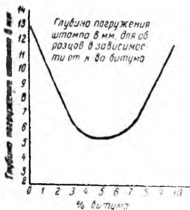
Рис. 5. Глубина погружения штампа в зависимости от содержания битума
