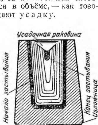
Фиг. 6. Образование усадочной раковины
